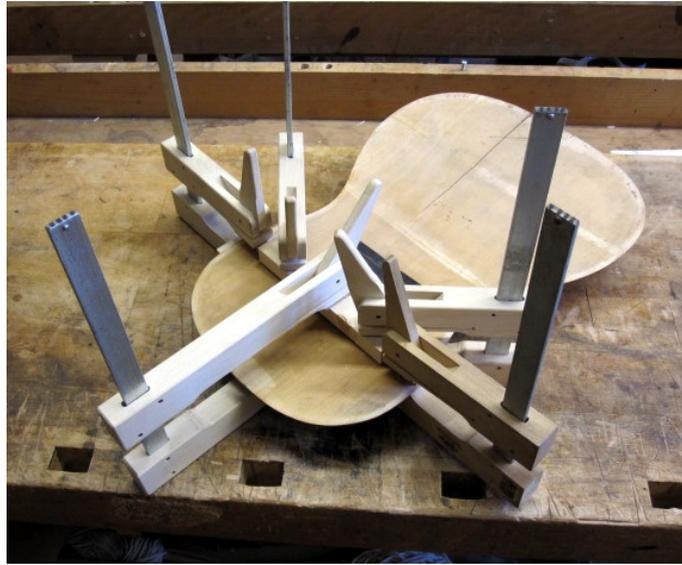
Nach dem Reinigen der Leimflächen wurde der obere und mittlere Bodenbalken wieder aufgeleimt (Hautleim).
